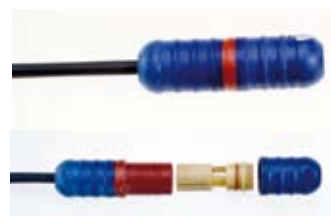
■ Bild 5: Die Heizbänder können ohne Spezialwerkzeug montiert werden. Die Schraubanschlusstechnik, bestehend aus Hülse, Klemmschneideinsatz und Gegenstück, sorgt für die sichere Verbindung.
