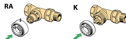
2. Den RA-Adapter mithilfe des 2-mm-Inbusschlüssels festziehen. Den Adapter für M30-1,5-Anschluss von Hand festziehen (max. 5 Nm).
