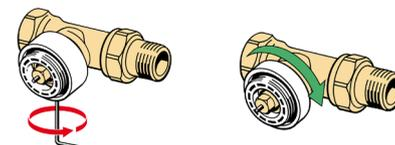
3. Den Thermostat auf den Adapter schrauben und handfest anziehen (max. 5 Nm).
