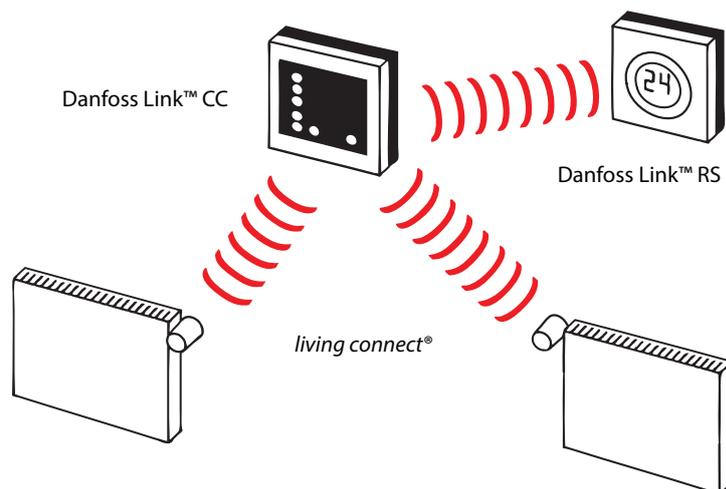
Die Temperatureinstellung kann bei *living connect*<sup>®</sup> über die Tasten oder über das Danfoss Link<sup>™</sup> CC geändert werden.
